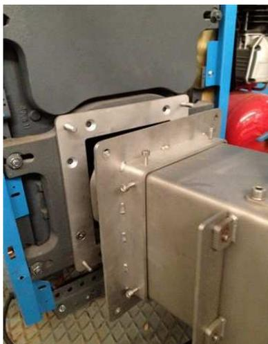
Limpiar el interior de la caldera con la ayuda de un aspirador de cenizas o de algún otro útil apropiado, por el hueco del quemador.
